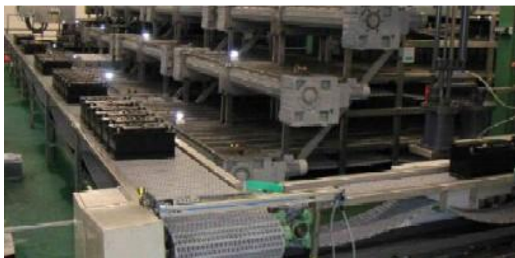
Modular Belt ทนกรดทนด่างได้ดี
